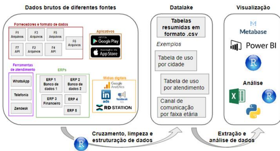
Figura 18. Exemplo de fluxo de dados com a arquitetura de Data Lake
